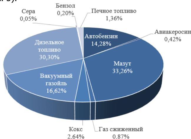
Рис. 5. Структура получаемых продуктов на АНПЗ
