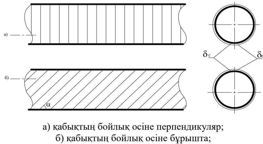
Сурет 2. Қабықтың корпусына ораманың схемасы
